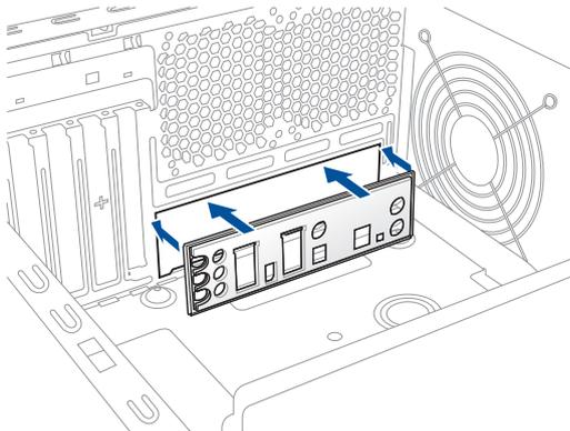
2. PCケースとマザーボードのバックパネルの位置が一致していることを確認してバックパネル側から慎重に挿入し、マザーボードのネジ穴とスペーサーが合うように設置します。
