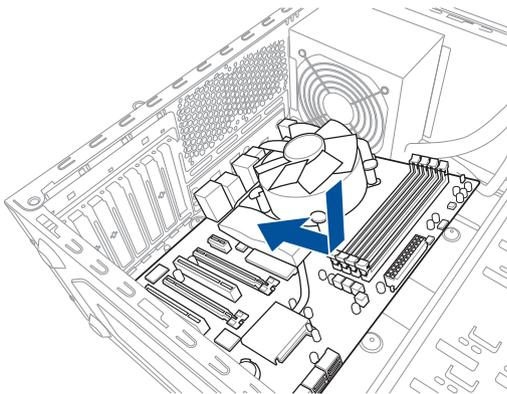
3. 下図を参考に、取り付けのネジをすべて仮止めし、対角線上に少しずつ締めていきます。
